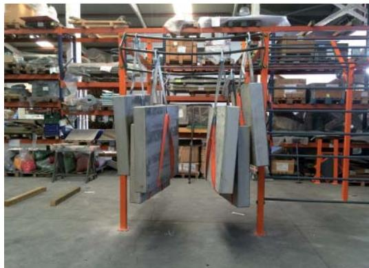
*Prototipo de Jaula Trainingbox realizando una prueba de carga para su posterior cumplimiento de la normativa EN-16630.*
